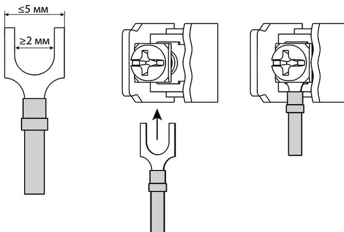
**Рисунок 9.2** Подключение проводов при помощи специальных наконечников
