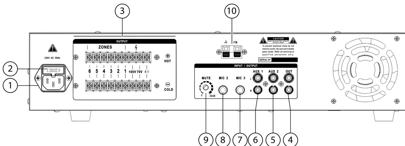
1. **Разъем питания** — разъем IEC-320-C14 для подключения шнура питания
