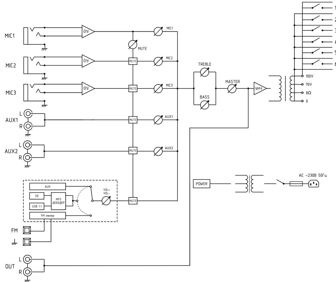
Рисунок Б.1 Функциональная схема ROXTON MZ-120, MZ-240, MZ-360
