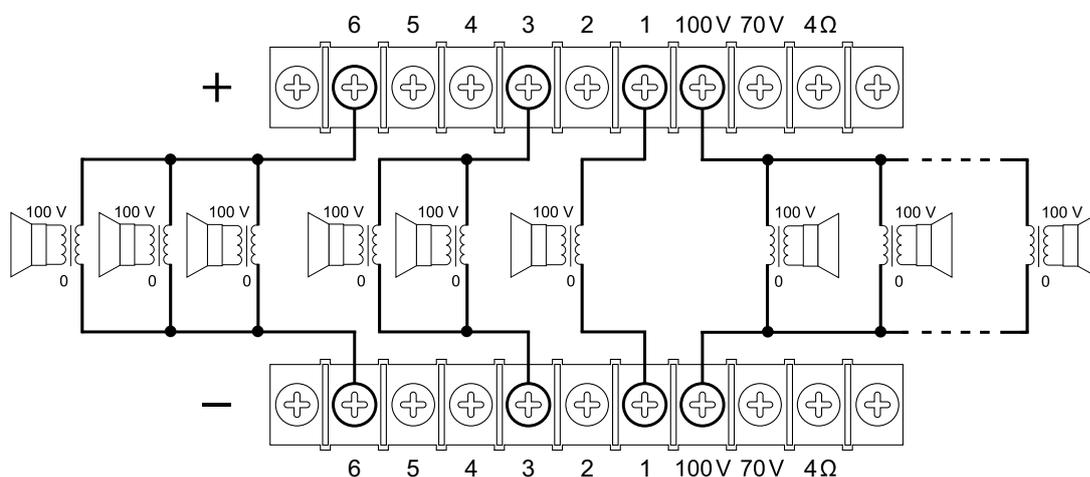
**Рисунок 9.3** Схема подключения трансляционных громкоговорителей
