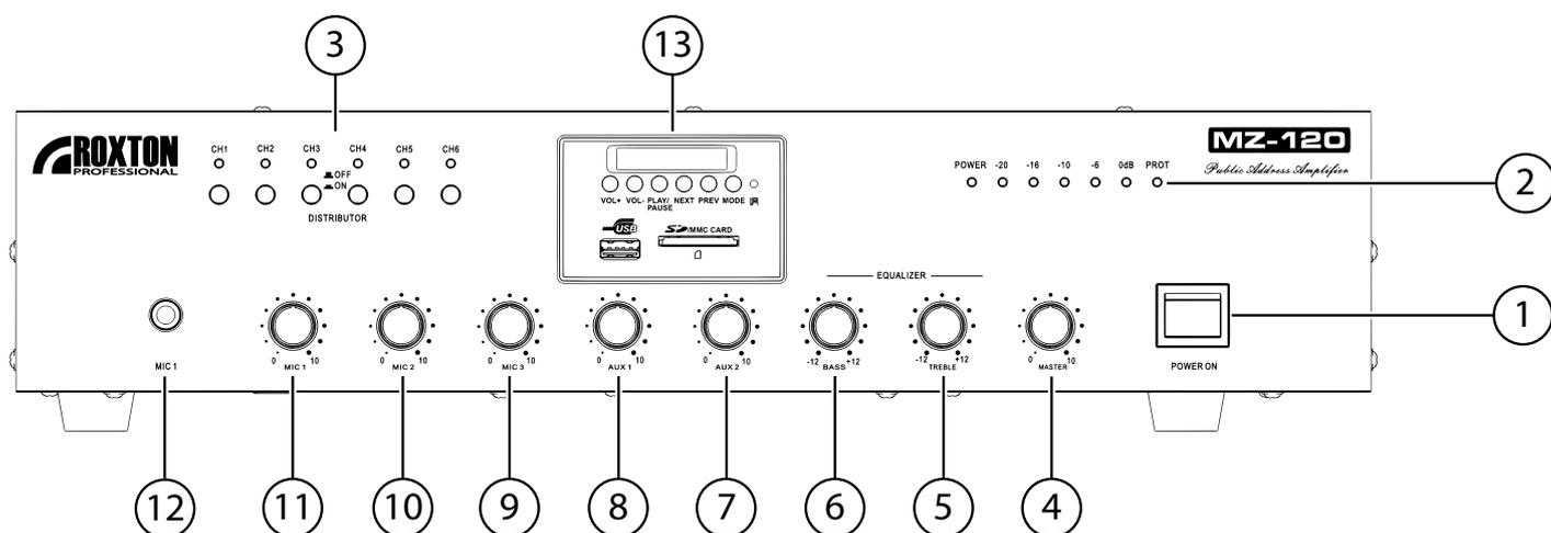
1. **Кнопка питания** — нажатие этой кнопки включает усилитель. При повторном нажатии усилитель выключается
